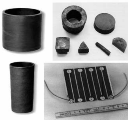
Rys.5. Elementy nadprzewodnikowe stosowane do budowy ograniczników prądu [1].
